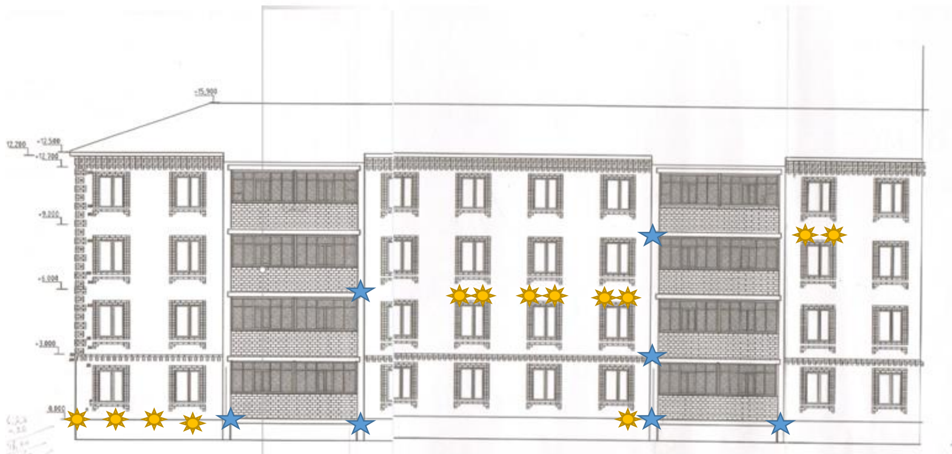
Рис. 16. Частота расположения типовых дефектов стенок лоджий и кирпичной облицовочной кладки 4,5 подъезда дома 24\2 по ул. Магистральная.
